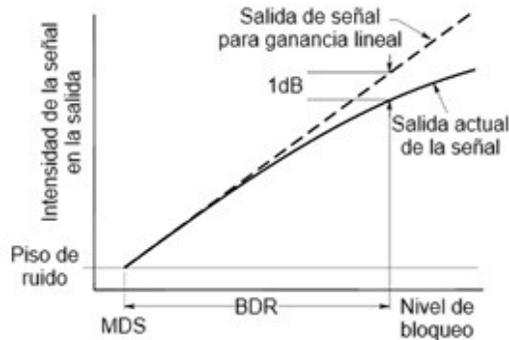
Figura 226. Rango dinámico de bloqueo. (Adaptado de ARRL (American Radio Relay League, 2024))
