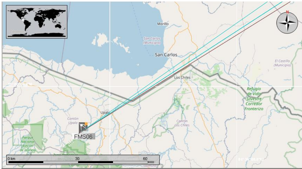
Imagen 3. Resultado de la medición de DF desde la estación del SNGME ubicada en Upala para la frecuencia 791 MHz proveniente de Nicaragua.
