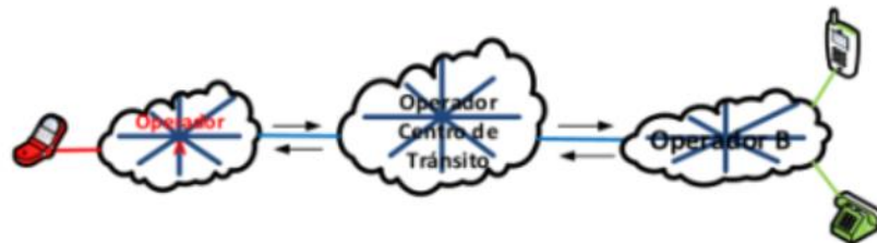
Figura 1: Operador destino con conexión directa
